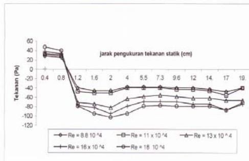
Gambar 11a. Distribusi tekanan statik pada permukaan benda uji untuk berbagai nilai Reynolds ( $Re$ ) dengan variasi sumbu mayor ( $a$ )= 20 mm.
